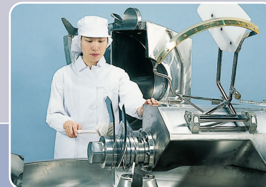
刃物カバー横開き装置 BLADE COVER SIDE OPENING SYSTEM 洗浄作業の安全性と容易な洗浄
