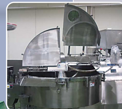
ノイズカバー NOISE COVER 飛散・騒音防止と安全性。
